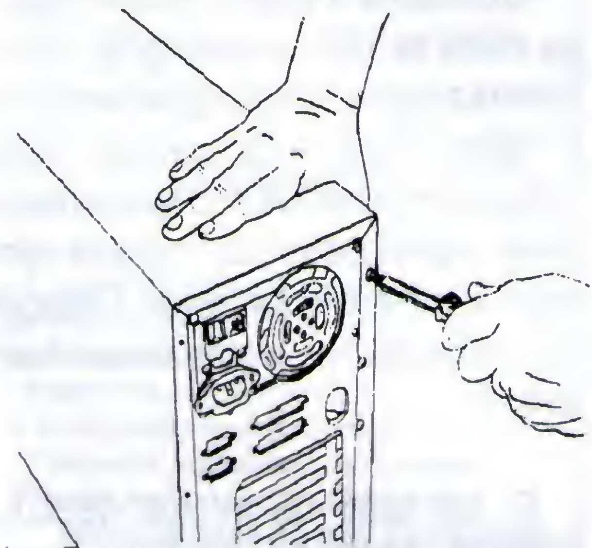
Figura 13 - abrindo o gabinete torre
